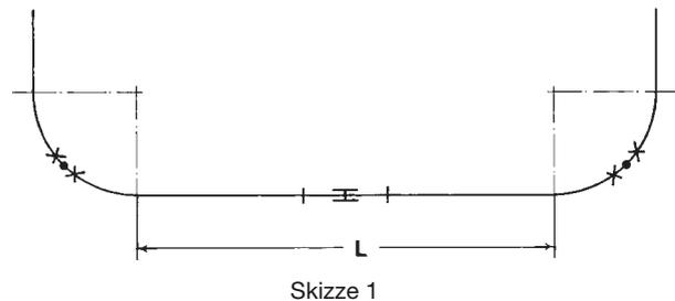
Die Dehnungslängen sind in der Mitte zwischen 2 Dehnungsteilstücken oder zwischen Dehnungsteilstücken und Anlagenende durch Sicherungsklemmen festzusetzen (Skizze 2).
